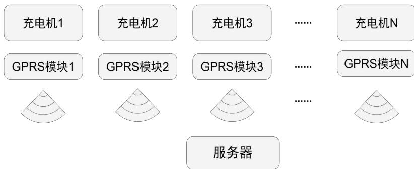
图 2-9 无线组网示意图
