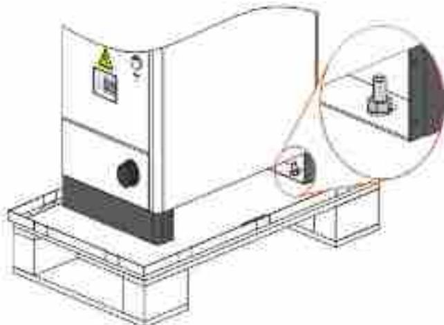
图 3-7 机器与木托架连接的螺栓位置
