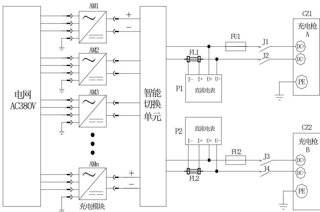
图 2-5 双枪充电桩原理框图
