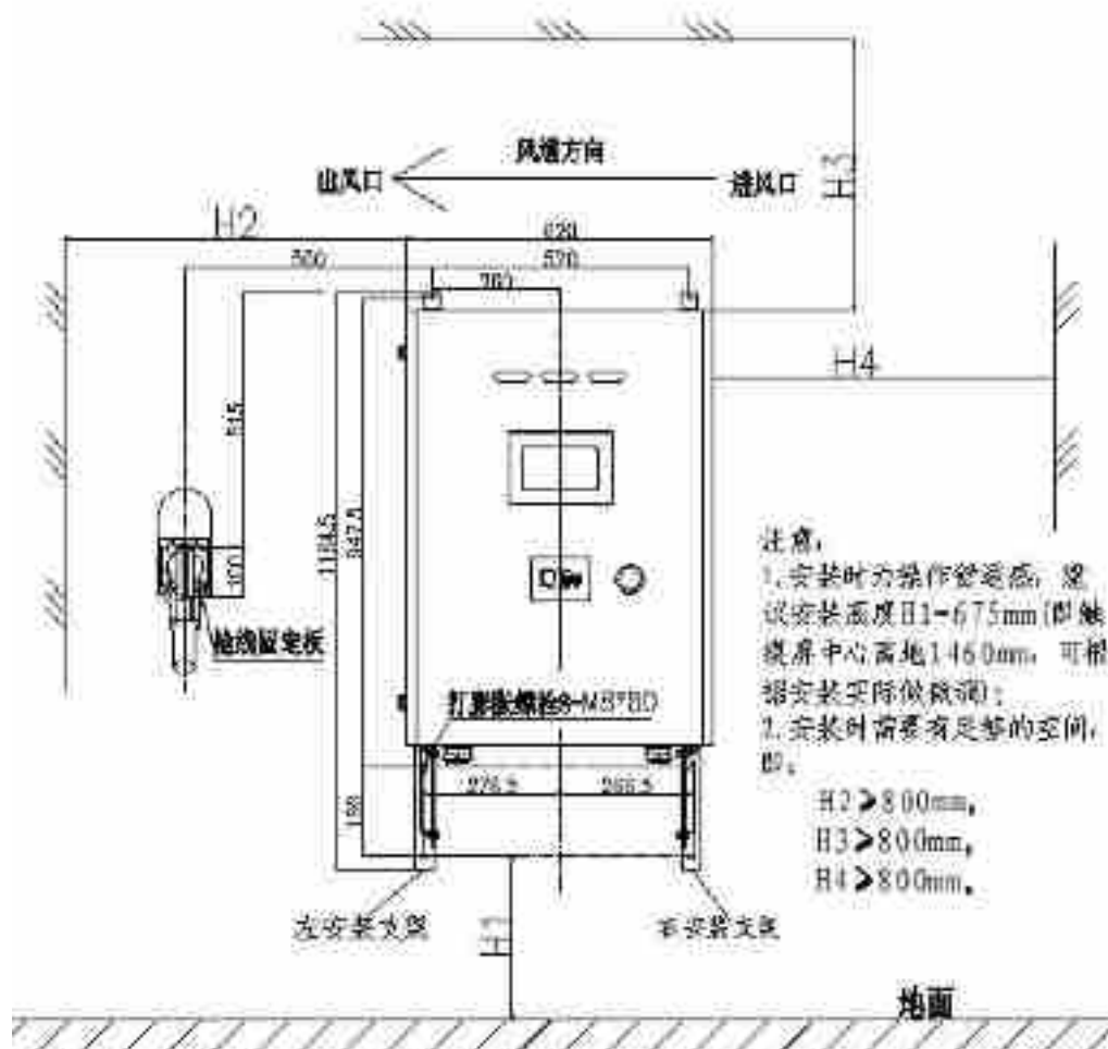
图 3-6 设备尺寸及安装空间示意图
