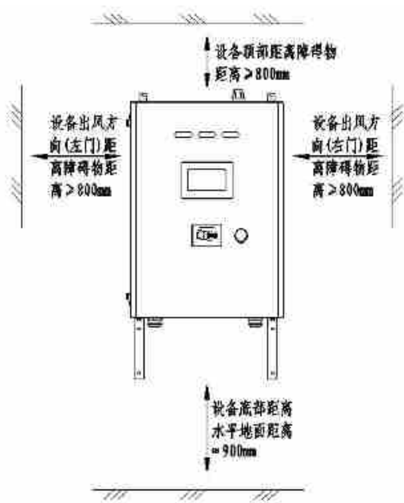
图 3-1 安装示意图
